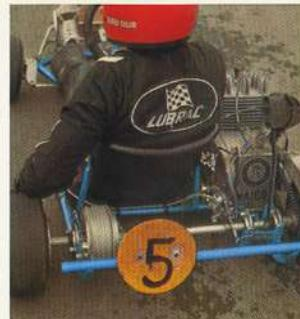
Der Antrieb der „Flitzer für die Kleinen“ geht vom Motor über einen Keilriemen auf die Hinterachse (siehe rechts neben dem Reifen). Die Motoren leisten ca. 18–22 PS und werden mit Normalbenzin angetrieben.
