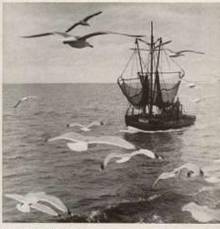
**Krabben-Kutter.** Eine besondere Erwerbsquelle an der Nordseeküste ist der Krabbenfang. Jeweils eine Stunde etwa schleppen der Krabbenkutter seine beiden Netze über den Wattboden, dann holt er sie auf, entleert sie und lässt sie wieder ins Wasser. Die großen Krabben werden gleich an Bord gekocht. Zentrum der nordfriesischen Krabbenfischer ist Büsum.
