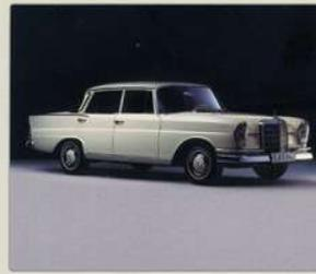
Die W111-Serie leitete eine neue Ära ein: Unter der Regie von Béla Barényi gewann in den 50er Jahren die passive Sicherheit groß an Bedeutung. Der 220 Sb erhielt eine Sicherheitszelle sowie Knautschzonen. Berühmt wurde er allerdings durch seine spitzen Peilstöße – weshalb man ihn auch „Heckfusse“ nannte.
