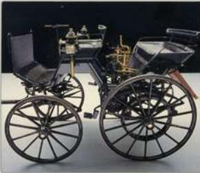
Gottlieb Daimler entwickelte die erste Kutsche ohne Pferd. An ihre Stelle traten Pferdeäulen. Der gemeinsam mit Wilhelm Maybach realisierte kleine, schnelllaufende Benzinmotor leistete 1,1 PS – genug für eine Höchstgeschwindigkeit von etwa 18 km/h.
