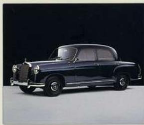
Der Typ 180 war der erste Mercedes-Benz Serien-PKW mit selbsttragender Karosserie. Die damals hochmoderne Form ohne Trennbretter und separate Kotflügel erinnerte an einen Ponton und sorgte für den Namen „Ponton-Mercedes“. Die hier abgebildete Dieselerosion gilt als nahezu unverwundlich.
